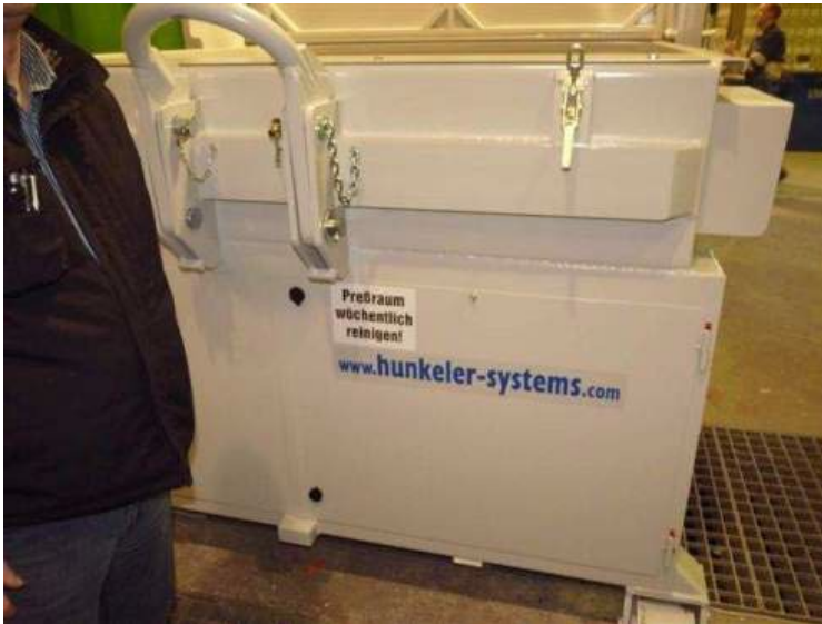
Bild: Wartungstür mit Vorgabe zur wöchentlichen Reinigung
